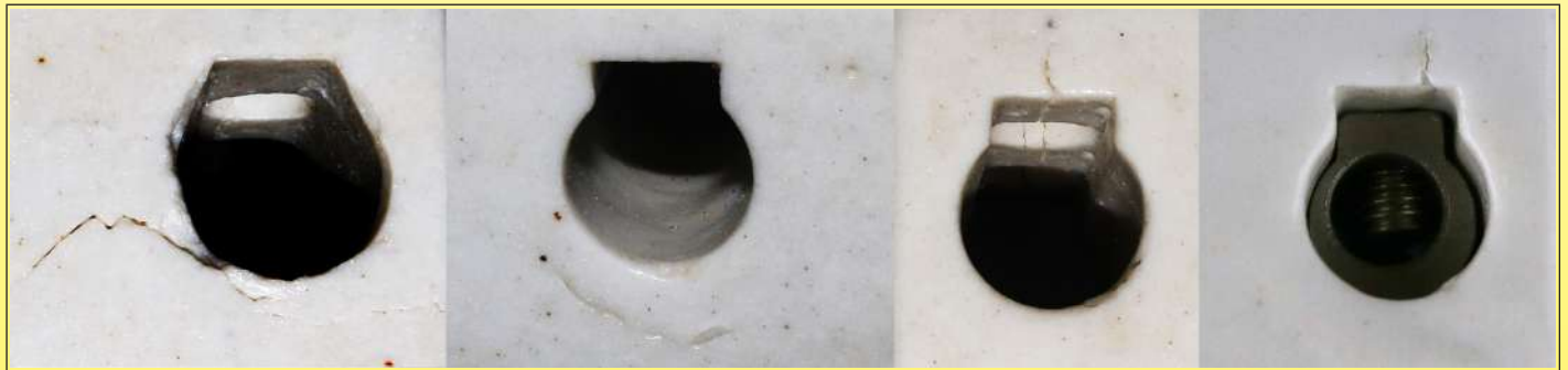
C111陶瓷的裂痕示例
